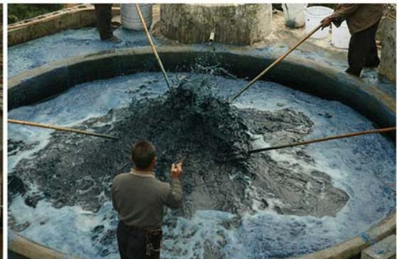
当开始往靛池中注入石灰水的时候，大家合力搅拌，使之混合均匀，待石灰槽放空，打靛的环节正式开始。五名村民均匀地散开，用打杆从不同角度用力地向中央推动池水，动作节奏整齐，富于韵律。池水被一下拨开涌向池边，一下又向中央汇集，往复运动，在池心激起半米多高的浪花，水声激越，水面生出厚厚的泡沫。老邱在打靛间歇的片刻舀起池水观察，甚至品尝，又加入少许石灰水继续打。浓绿的池水在激荡中逐渐转蓝，颜色越来越深厚，半个多小时后打靛结束，靛池中的液体已经变成蓝黑色，水面继续涌动了 1 刻钟才彻底平静下来。
