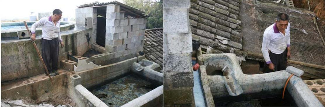
打好的靛液经过五个多小时的沉淀，老邱打开了靛池的出水口，排出上层澄清的液体。靛池的建造高低错落，为排水排靛设计了科学的通道，此时低处小靛池的入口是关闭的，排出的清液直接流走。靛池内的液面缓缓下降，越来越接近沉积在池底的靛泥层。
