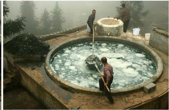
表面漂浮的叶子捞去之后，接下来清除池底的沉淀物。首先堵住存放废叶小圈的回流孔，沉降到池底的多是枝条，这一部分沥出的液体废弃不要。几名村民用长度超过两米五的打杆搅动池水旋转，巧妙地利用漩涡将沉积物集中在池底中心，等待池水停转后捞取。下一次他们换一个方向搅拌，然后再捞，这样的过程持续了一个小时，直至再也捞不出任何残渣为止。老邱自己趁这段时间将 80 斤生石灰溶解备用。
