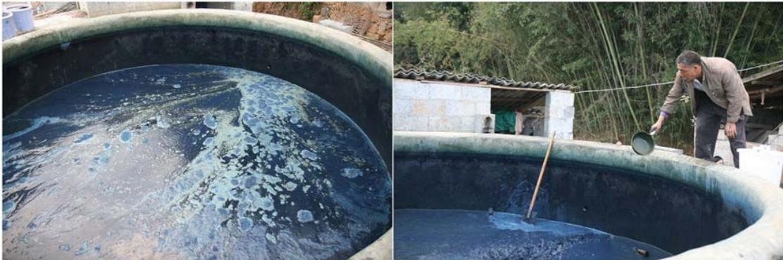
靛池的底面是倾斜的，两侧有 20 公分的落差，靛液自动缓缓集中到出靛孔的附近。老邱用事先收集的清液刷洗靛池，将池底的靛泥赶向出靛孔，半个小时后靛液全部流空，靛池底部没有留下一点残枝败叶，已经做好准备迎接下一池碧绿的蓝叶。
