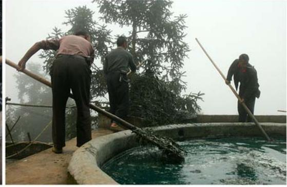
邱家的水泥靛池由于排水的需要建在高台之上，直径 435 厘米，平均深度 90 厘米。靛池投入 900-1000 斤蓝草枝叶，注水之后的浸泡深度将近 70 厘米。此时当地白天的最高气温还能达到 20 度左右，蓝草枝叶经过 3 天的浸泡已经变软发黑，拨开可见水色呈现浓郁的灰绿色，此时便可捞叶打靛了。一大早浓雾未散，老邱的哥哥和另外 3 名村民如约前来帮忙，将漂浮的叶子捞起堆在池边的小圈里，沥出的液体流回池中一点也不浪费。
