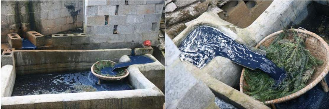
老邱一直留意着排水的状况，随时舀起一瓢仔细观察，65 分钟后表层的清液基本排空，老邱堵住向外界排放的出口，同时打开二级靛池的入口，此后大靛池流出的液体全部进入小靛池存储。随后大靛池比排水孔低 20 多公分的出靛孔也打开了，深蓝浓稠的靛液汩汩流出。老邱在小靛池内铺垫了竹筛和刺衫的叶子，再一次过滤残渣。
